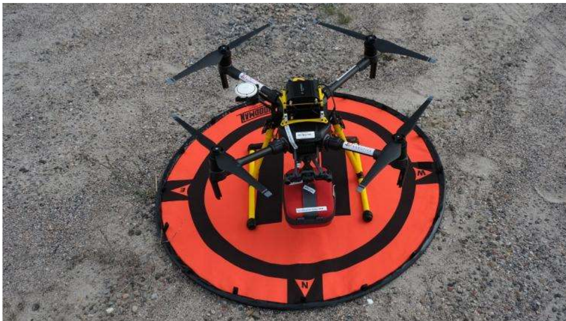
図 30 レンブリューで行われた AED ドローン飛行実験に使用された機種 InDro M210C (Indro Robotics 社製)
