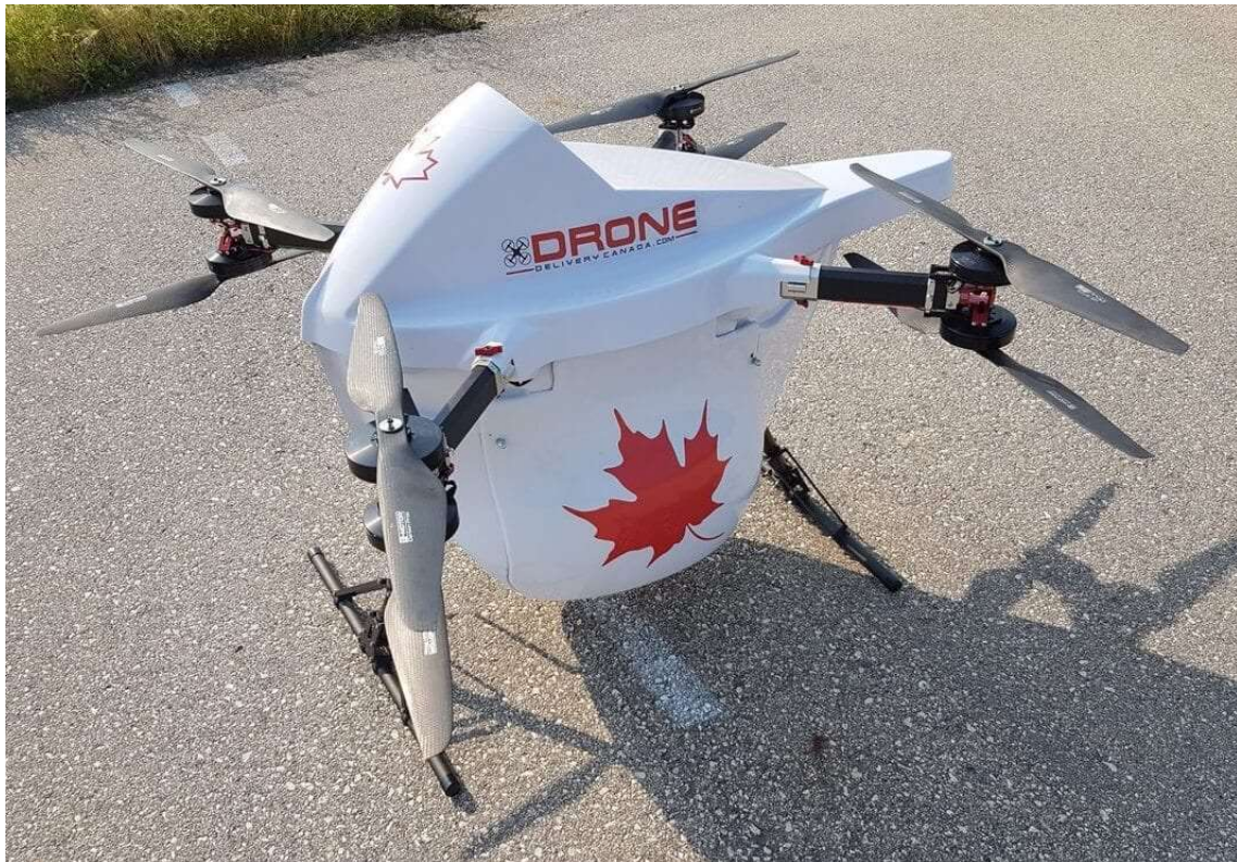
図 29 カレドンにて実施された AED ドローン飛行実験に使用された機種 Sparrow X1000 (Drone Delivery Canada 社製)
