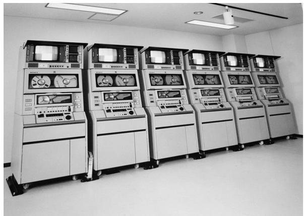
写真5 設立当初の放送大学で使われていた1インチVTR
