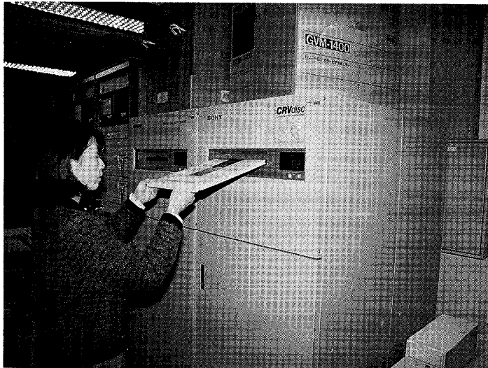
写真 4-7 サマリーサブシステム 光ディスクオートチェンジャー (50枚収納)
