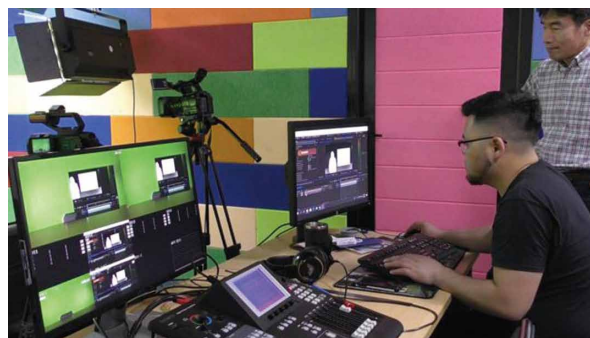
写真18 モンゴル国立大学の新スタジオの機器をDigital AV Mixer AG-HMX100を中心に再構成を図った
